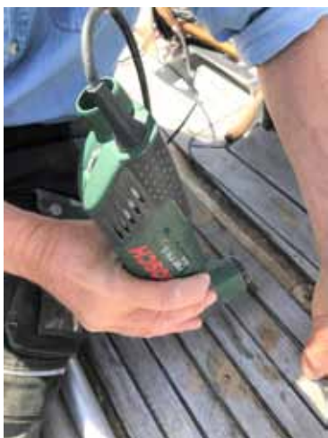
Bild 1 Pluggar och skruvar tas bort. En multima-skin skär upp nåten så lösa teakribbor kan försiktigt lossas med mejsel och spackelspade.
