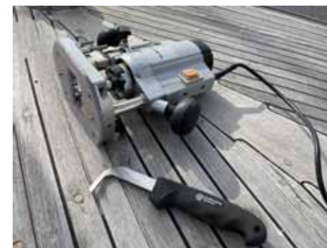
Bild 6 Nåtremsning med nåtskrapa. Fördjupning av nåten med handöverfräs försedd med hemmagjord styrplatta som följer nåten.
